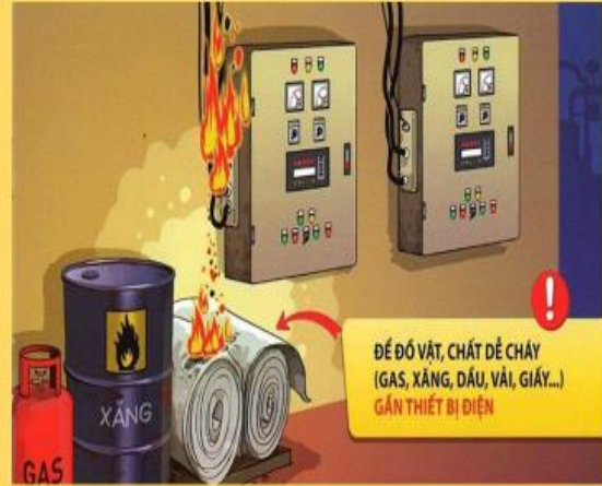
Để các vật dễ cháy gần các thiết bị điện
