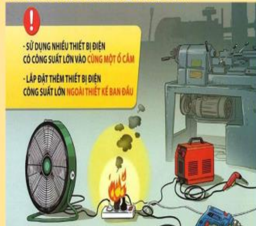
Sử dụng nhiều thiết bị có công suất lớn cùng 1 ổ cắm
